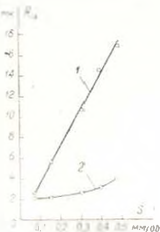
Рис. 2. Зависимость микронеровностей от подачи при обработке стали 45 ( v = 120 м/мин, \gamma = 45^\circ ): 1 — обычный резец; 2 — резец БРМ-1.
