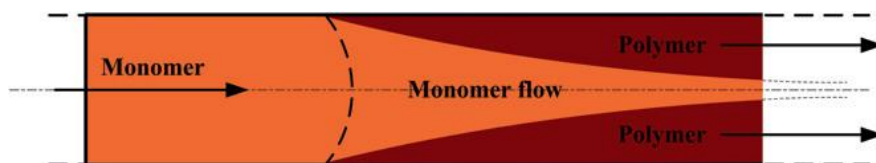
Рис.1. Струя мономера через полимер в трубчатом реакторе ФП.
