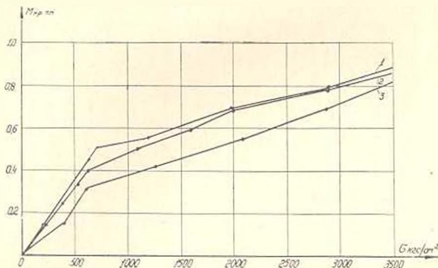
Рис. 5 Средние напряжения в хомутах балок, армированных продольными стержнями и хомутами. 1. Балка из тяжелого бетона Б-I—2. 2. Балка из легкого бетона Б-II—1. 3. Балка из легкого бетона Б-IV—7.
