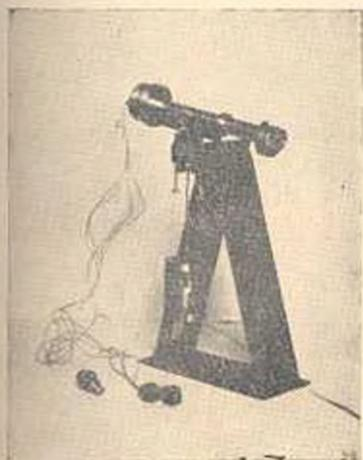
Рис. 7. Датчик зенитального вращения.
