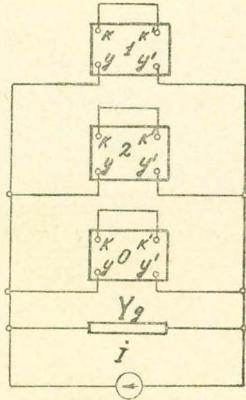
Рис. 8. Комплексная схема замещения по месту двухфазного замыкания на землю в ветви  $y-y'$  определяющая  $E_{y\bar{y}}^{(1,1)}$ .
