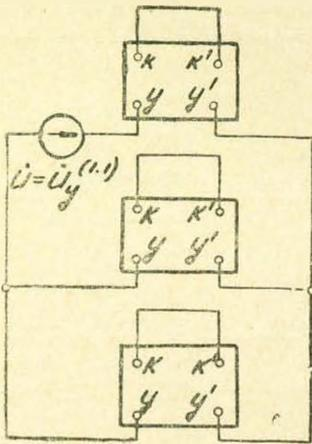
Рас. 9. Комплексная схема смещения по месту двухфазного замыкания на землю в ветви  $y - y'$  и трехфазного замыкания на землю в ветви  $k - k'$  определяющая  $E_{y\bar{y}}^{(1,1)}$ ,  $I_{y\bar{y}}^{(1,1)}$  и  $I_{k\bar{k}'}^{(3)}$ .
