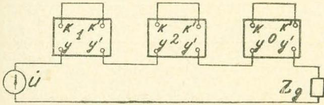
Рис. 7. Комплексная схема замещения по месту однофазного замыкания на землю в ветви  $y-y'$ , определяющая  $\Delta I_{y0}^{(1)}$ .
