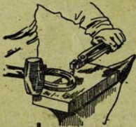
Նկ. 53. ա—բռնիչային դղեը զոդելը, Ե—նրա վերջնական մշակումը:
