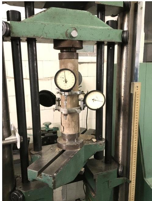
Фиг. 1: Цементогрунтный образец, установленный на испытательной машине
