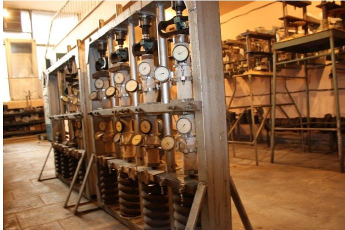
Фиг. 2: Силовая установка для испытания цементогрунтовых образцов на длительное сжатие в рабочем состоянии
