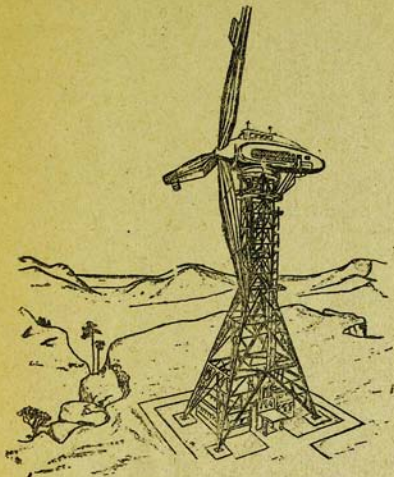
Նկ. 30. 2000 կվտ հողմանիվարտիան տեղակայումի ընդհանուր տեսքը: Պլատֆորմի թաքմբությունն և 50 մետր: Անդրի տրամագիծն և 50 մետր:
