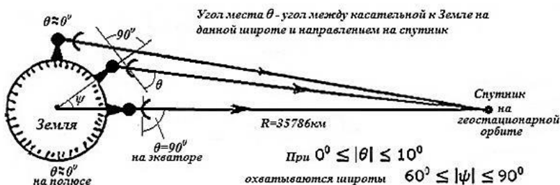
Рис. 22. Радиолинии Земля – искусственный спутник на геостационарной орбите при случае \vartheta - \varphi = 0 .
