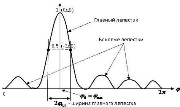
Рис. 15. ДН в прямоугольной системе координат.
