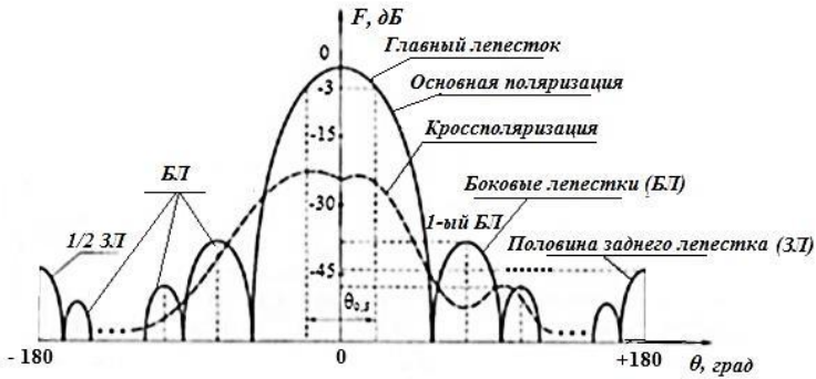
Рис. 16. Общий вид идеализированных ДН на основной поляризации и кроссполяризации в прямоугольных координатах.
