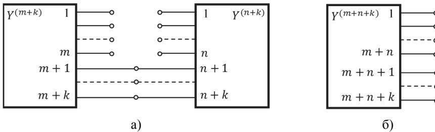
Рис. 7. Соединение  $(m+k)$ - и  $(n+k)$  - клеммников (а) и результирующий  $(m+n+k)$  - клеммник (б)
