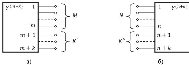
Рис. 6.  $(m + k)$  (а) и  $(n + k)$  (б) клеммники
