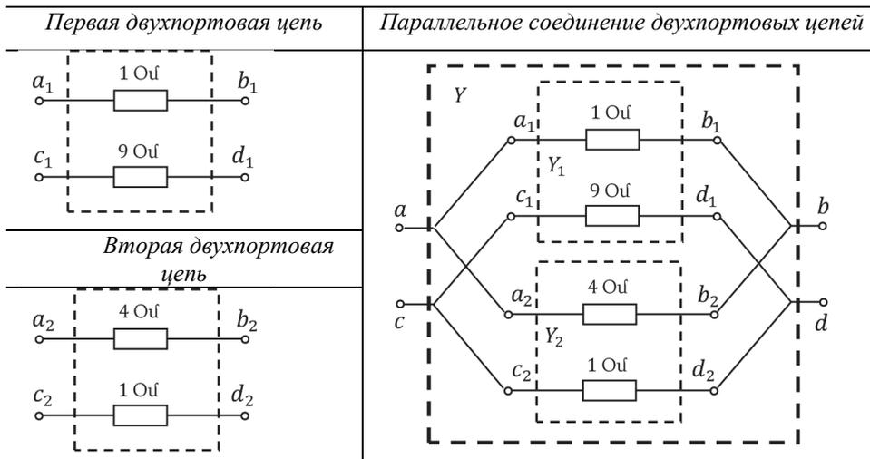
В [8] приведено параллельное соединение двух  $m$  – клеммников (рис.4а) путем попарного соединения клемм. При известных матрицах узловых проводимостей  $Y_1, Y_2$  первого и второго  $m$  – клеммников матрица  $Y$  результирующего многоклеммника (рис.4б) получится путем сложения матриц  $Y_1$  и  $Y_2$  [8]:
