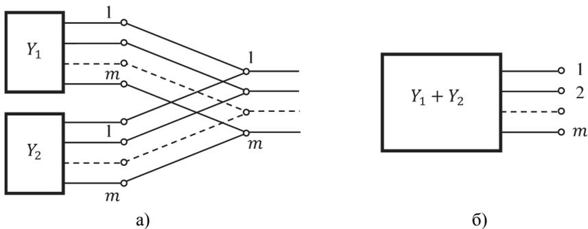
Рис.4. Параллельное соединение двух  $m$  – клеммников (а) и результирующий многоклеммник (б)
