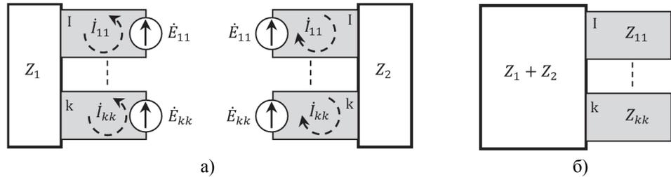
Рис. 5. Электрические цепи с выделенными ячейками (а) и результирующая схема (б)
