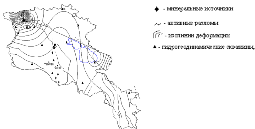
Рис. 4. Карта напряженно-деформированного состояния земной коры Армении за 2019 г.
