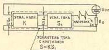
Фиг. 1. Принципиальная схема стабилизаторов тока.
