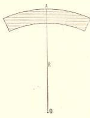
Фиг. 2. Отражающие плоскости неизогнуты и перпендикулярны центральному радиусу. OA=R —центральный радиус.
