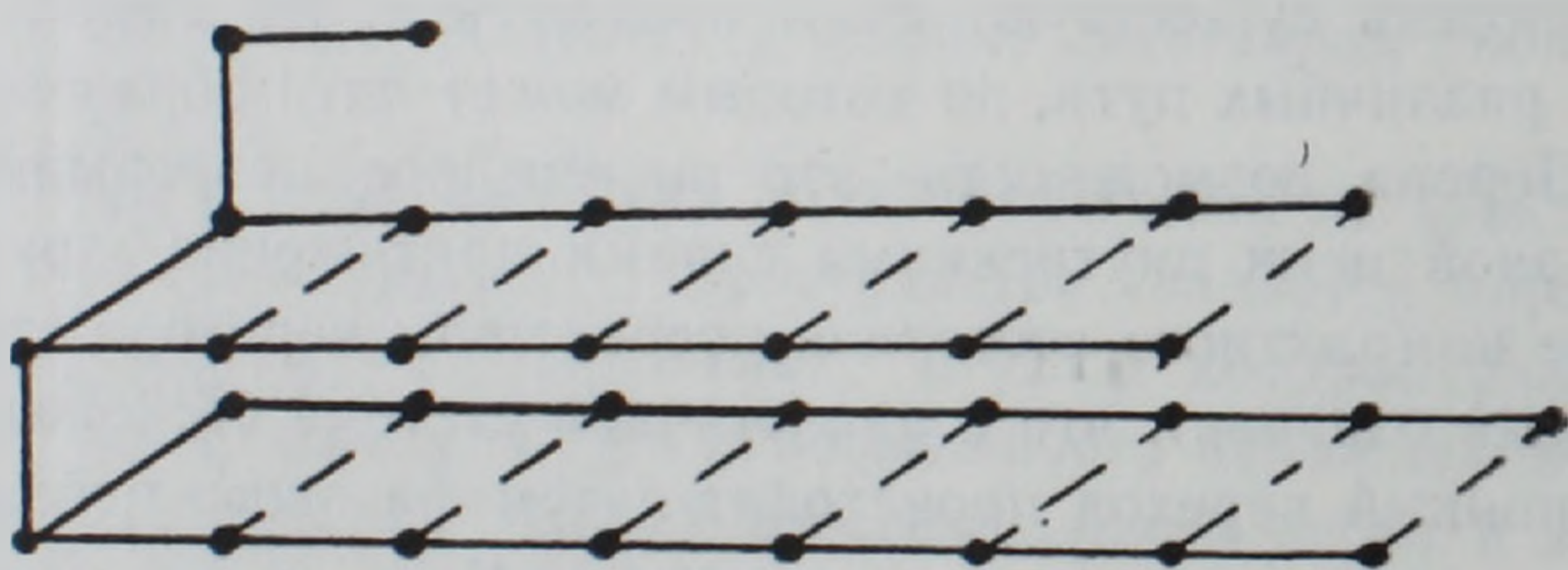
Рис. 2. Одна из образовавшихся кристаллических конфигураций (число контактов равно 58) жесткой цепи из 64 звеньев ( W = \frac{1}{32} ). Пунктиром указаны горизонтальные контакты.
