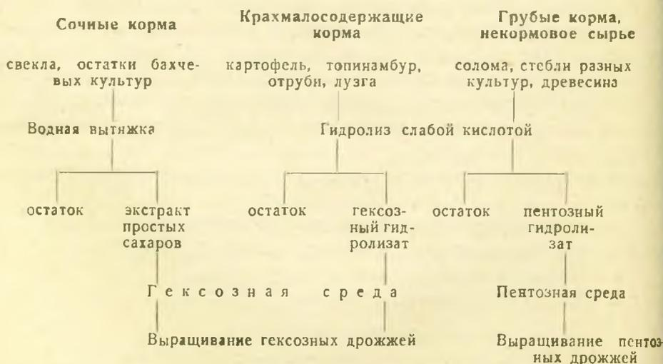
Опыт был поставлен в лабораторных и производственных условиях. Лабораторные опыты были проведены на 25—50 г сырья как для водной экстракции свеклы, так и для гидролиза картофеля, отрубей, лузги и соломы.
