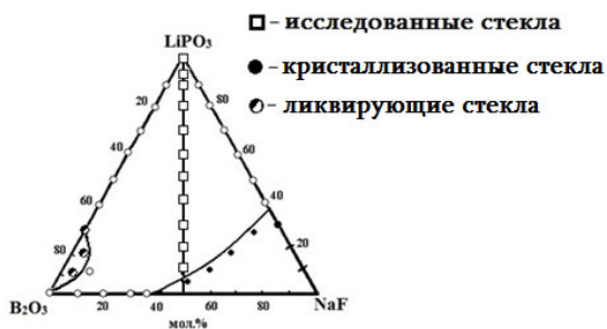
Рис. 1. Область стеклообразования в системы \text{LiPO}_3\text{-B}_2\text{O}_3\text{-NaF} и составы исследованных стекол с постоянным молярным соотношением \text{B}_2\text{O}_3/\text{NaF} = 1/1 .
