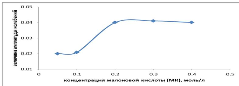
Рис. 16. Зависимость величины амплитуды колебаний оптической плотности раствора от концентрации малоновой кислоты.
