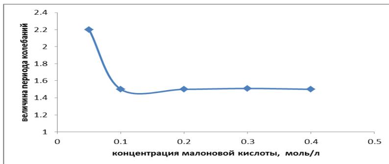
Рис. 19. Зависимость величины периода колебаний оптической плотности раствора от концентрации малоновой кислоты.
