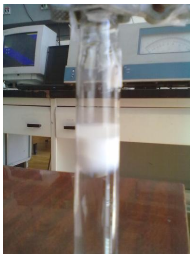
Рис.1. Локальное помутнение водной фазы в статической системе винилацетат – водный раствор персульфата калия в присутствии этанола.
