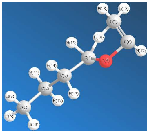
Рис. 3. ПС при активации молекулы ВБЭ, полученное по программе ChemBio Ultra 11.0.
