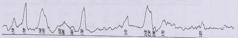
Рис.5. Дифрактограмма смеси СГМg-NaCl после ВТРА, охлажденной от  $t=900^\circ\text{C}$  до комнатной температуры.
