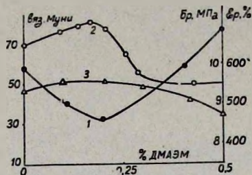
Рис. 2. Зависимость свойств каучуков (1) и вулканизатов (2, 3) от содержания ДМАЭМА: 1 — вязкость по Муни при 100^\circ , 2 — предел прочности при разрыве, 3 — относительное удлинение при разрыве.
