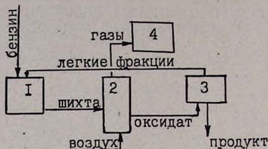
Рис. Принципиальная схема окисления углеводородов до монокарбоновых кислот: 1 — шихтоприготовитель, 2 — реактор, 3 — система ректификации, 4 — система конденсации отходящих газов.
