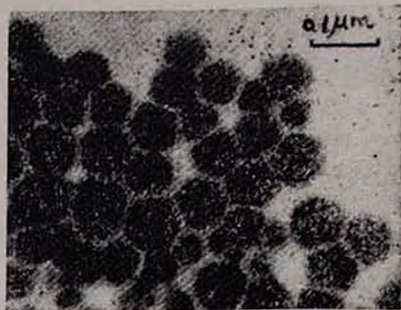
Рис. 1. Электронная микрофотография частиц сополимерного латекса, полученного методом 1.
