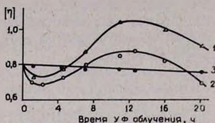
Рис. 1. Изменение характеристической вязкости сополимера без стабилизатора (2) и содержащего 2% фенольного (3) и фосфорсодержащего (1) стабилизаторов в зависимости от времени УФ облучения.
