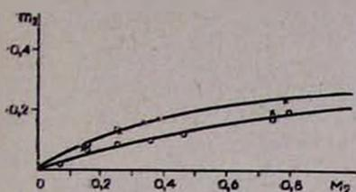
Рис. 1. Зависимость мольной доли мономера  $M_2$  в сополимере ( $m_2$ ) от его мольной доли в смеси мономеров ( $M_2$ ), при сополимеризации с ЭХГ ( $M_1$ ) в массе под действием 2 мол. % катализатора: 1 — циануксусный эфир, кат.  $SbCl_3$  при  $0^\circ$ , 2 — циануксусный эфир, кат.  $SnCl_4$  при  $0^\circ$ , 3 —  $\gamma,\gamma$ -дицианпимелонитрил, кат.  $SnCl_4$  при  $35^\circ$ .
