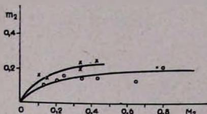
Рис. 2. Зависимость мольной доли циануксусного эфира в сополимере ( $m_2$ ) от его мольной доли в смеси мономеров ( $M_2$ ) при сополимеризации с ТГФ ( $M_1$ ) в массе, под действием 2 мол. % катализатора: 1 — ЭФБ, 2 —  $SbCl_3$ .
