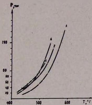
Рис. 1. Второй предел самовоспламенения смеси  $2\text{CO} + \text{O}_2 + 5,7\% \text{H}_2$ ; 1 — измеренный экспериментально; 2 — рассчитанный на ЭВМ с учетом реакции гетерогенного радикального распада перекиси водорода; 3 — рассчитанный на ЭВМ при значении  $K_{12c}$ , рекомендуемой в литературе; 4 — рассчитанный на ЭВМ с  $K_{12c}$ , увеличенной в 3,7 раза.
