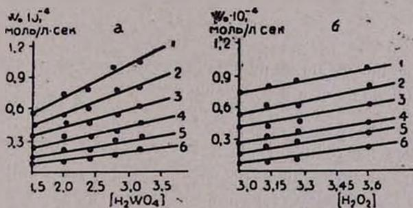
Рис. 1. Зависимость начальных скоростей эпексидирования малеиновой кислоты от концентрации перекиси водорода (б) и вольфрамовой кислоты (а). 1, 2 —  $[H_2O_2] = 3,59$  и  $3,00$  (а), соответственно при  $75^\circ$ ; 3, 4 — то же при  $65^\circ$ ; 5, 6 — то же при  $45^\circ$ ; 1, 5 —  $[H_2WO_4] \cdot 10^2 = 3,12$  и  $1,56$  (б) соответственно при  $75^\circ$ ; 2, 4 — то же при  $65^\circ$ ; 3, 6 — то же при  $45^\circ$ .
