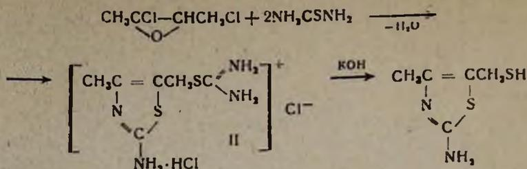
Структура меркаптометилтиазола установлена данными ИК спектров, в которых имеются поглощения при 1635 (тиазол I), 1545, 1475 (тиазол II) и 1385  $\text{см}^{-1}$  (скелет тиазола) [5].
