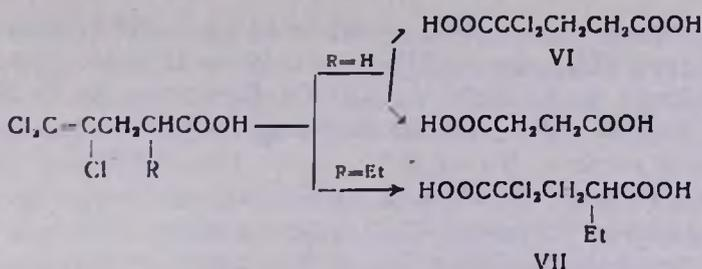
При перегонке VI и VII не превращаются в лактонокислоты. Из III получены  $\alpha$ -метил- $\alpha$ -хлорглутаровая (продукт ОП) и  $\gamma$ -валеролактон- $\gamma$ -карбоновая кислоты (продукт циклизации).
