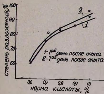
Рис. 5. Зависимость степени разложения апатитового концентрата от нормы кислоты в пересчете на бисульфат аммония.
