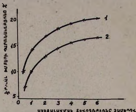
Նկ. 3. Պոլիմերի ֆորմալի ացետալացումը քացախալոգնիդով: Մեթիլալային խմբերի «կզբնական» պարունակութիւնը՝ 1— 20,20\% , 2— 24,70\% :
