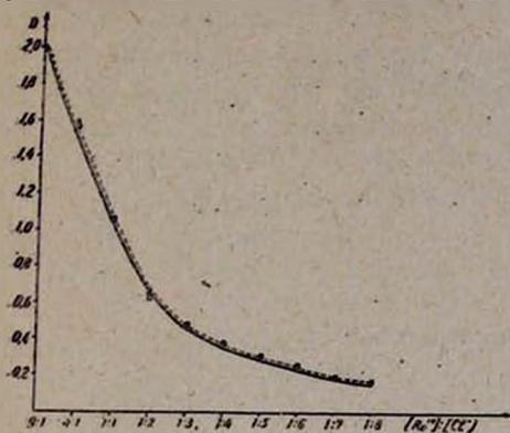
Рис. 5. Изомолярная серия системы  $\text{Re}^{\text{IV}}-\text{Cl}^-$  на фоне избытка роданида (пунктиром обозначен контрольный раствор, не содержащий  $\text{Cl}^-$ ; общая концентрация  $\text{Re}^{\text{IV}}$  и  $\text{Cl}^-$   $5 \cdot 10^{-4}$  моль/л).
