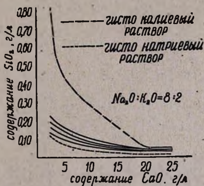
Рис. 5. Обескремнивание алюминатных растворов, содержащих 3,7 г/л \text{SiO}_2 , с соотношением \text{Na}_2\text{O} : \text{K}_2\text{O} = 8 : 2 .
