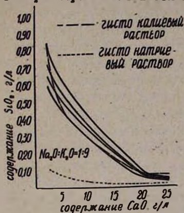
Рис. 2. Обескремнивание алюминатных растворов, содержащих 3,7 г/л \text{SiO}_2 , с соотношением \text{Na}_2\text{O} : \text{K}_2\text{O} = 1 : 9 .
