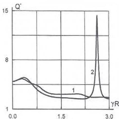
Фиг. 5. Изменение относительного суммарного электрического заряда на электроде в функции нормализованного волнового числа  $\beta_1 = \pi/6$ ,  $\beta_2 = 6$ ,  $\beta_3 = 7\pi/6$ ,  $\beta_4 = 11\pi/6$ .
