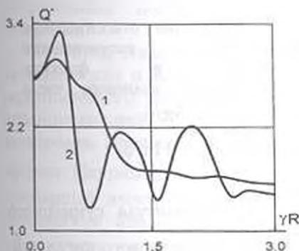
Фиг. 2. Изменение относительного суммарного электрического заряда на электроде в функции нормализованного волнового числа
