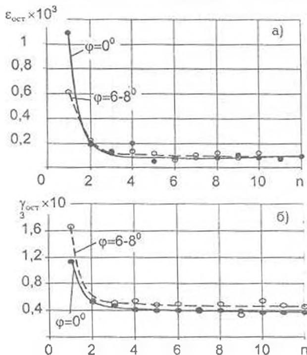
Фиг. 3. Кривые изменения остаточных продольных (а) и сдвиговых (б) деформаций цикла стеклотканевых труб с углом армирования  $\phi=0^\circ$  и  $\phi=6-8^\circ$  в зависимости от номера цикла испытаний.
