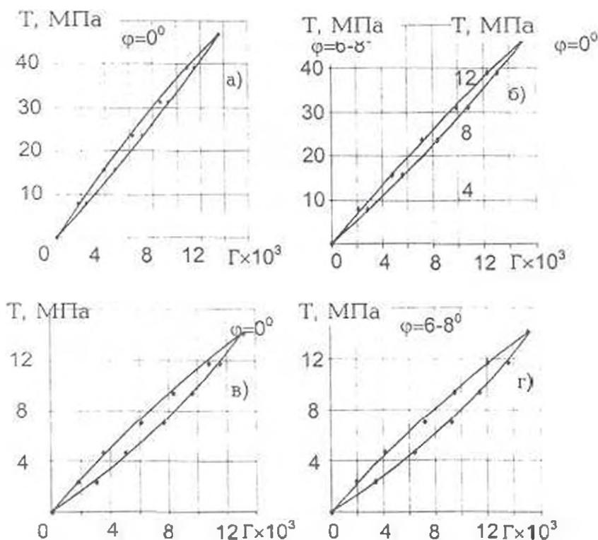
Фиг. 4. Кривые петли гистерезиса, построенные согласно зависимости (8), в случае осевого растяжения и простого кручения стеклотканевых труб с φ=0° (а и в) и труб с φ=6-8° (б и г).
