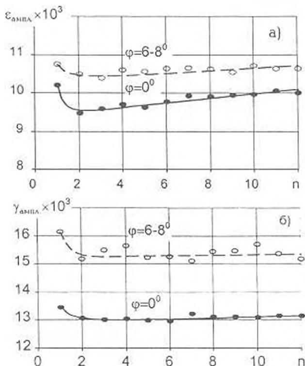
Фиг. 2. Кривые изменения амплитудных продольных (а) и сдвиговых (б) деформаций цикла стеклотканевых труб с углом армирования  $\varphi=0^\circ$  и  $\varphi=6-8^\circ$  в зависимости от номера цикла испытаний.
