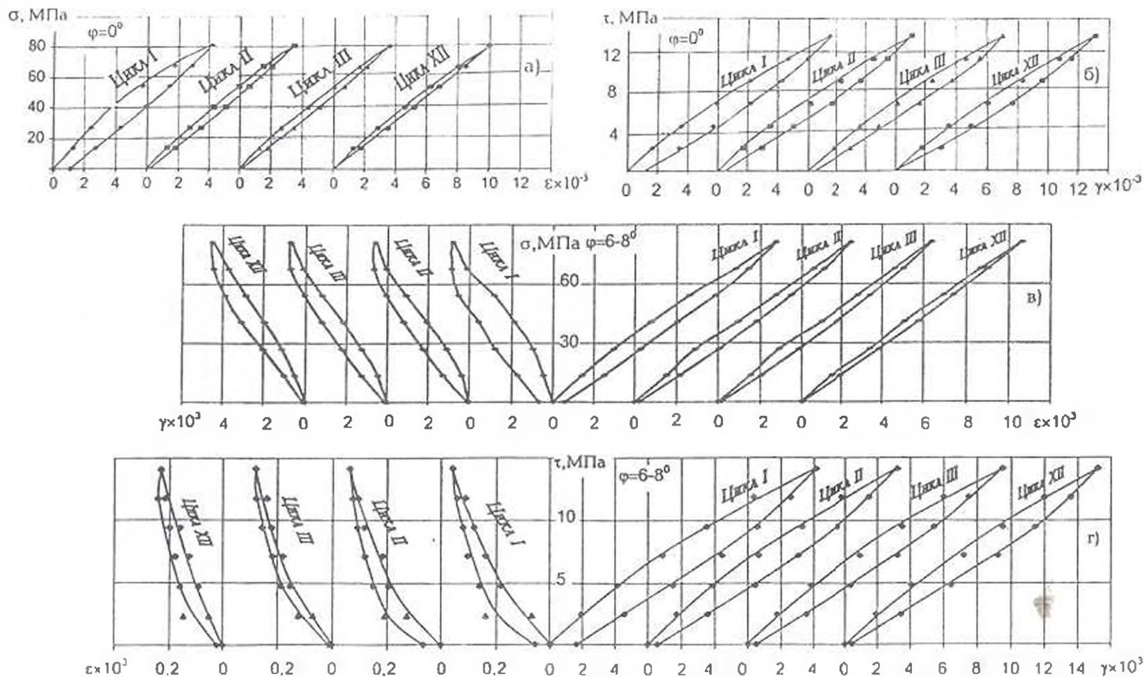
Фиг. 1 Диаграммы деформирования в пределах цикла в режиме нагружения-разгрузки в условиях осевого растяжения и простого кручения стеклотканевых труб с углом армирования  $\varphi=0^\circ$  [а и б) и  $\varphi=6-8^\circ$  [в и г).
