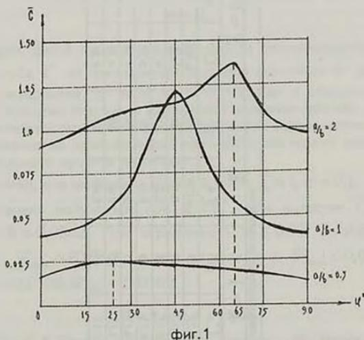
На графиках фиг. 1 для случая однонаправленного углепластика показаны изменения максимального прогиба  $\bar{C}$  в зависимости от угла укладки  $\varphi$  при  $\bar{h} = 0,1, \bar{x} = 1$  для значений  $a/b = 0,5; 1, 2$ .
