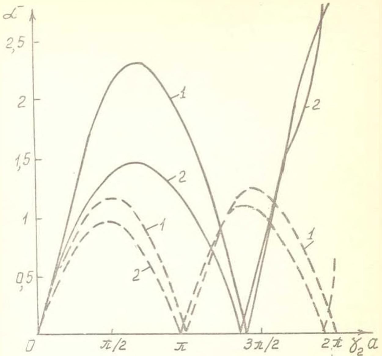
Фиг. 2 График зависимости величины  $\alpha^-$  от нормализованного волнового числа  $\gamma_2 a$  для прямой поперечной и параболической трещины в полустое со свободным торцом.
