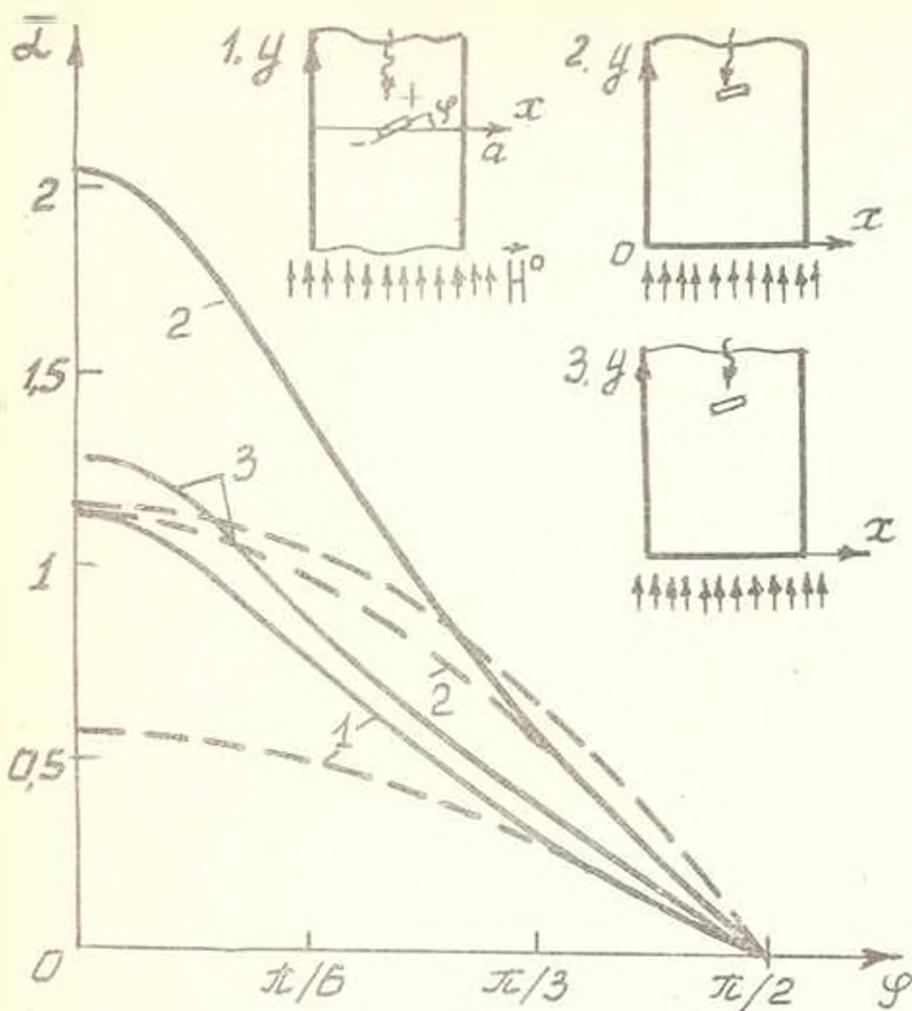
Фиг. 1. График зависимости величины  $\bar{K}$  от угла ориентации  $\varphi$  прямолинейной трещины.
