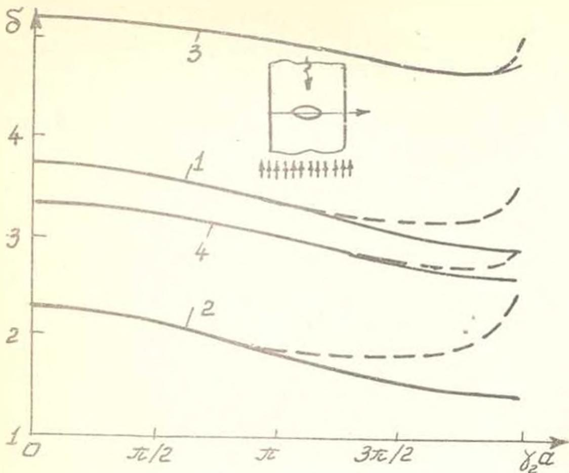
Фиг.3. График зависимости величины  $\delta$  от нормализованного волнового числа  $\gamma_2 a$ , для круговой и эллиптической полости в слое
