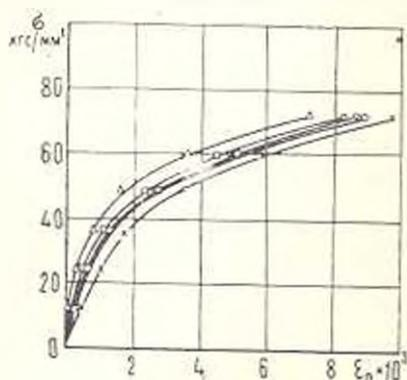
Фиг. 3. Зависимость деформации ползучести от напряжения:  $\Delta$  — 2 дня,  $\square$  — 10 дней,  $\nabla$  — 20 дней,  $\circ$  — 30 дней,  $\times$  — 100 дней.
