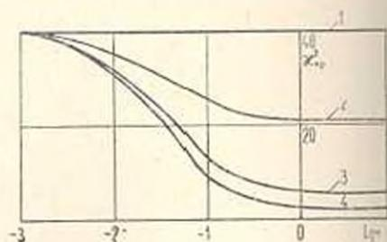
Фиг. 3. Зависимость критической силы от величины  $k$  при 1 условиях на концы стержня. Отмеченные линии соответствуют следующим значениям  $\nu$ : 1— $\nu=1$ ; 2— $\nu=0.5$ ; 3— $\nu=0.1$ ; 4— $\nu=0.01$
