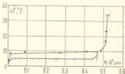
Фиг. 4. Влияние концентратора на разогрев \psi = 45^\circ , \sigma_{\max} = 6.60 \pm 0.10 \text{ кг/мм}^2
