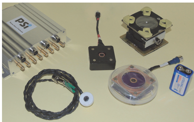
Рис.1. Различные конструкции радиочастотных «магнитно-полевых» SFCO-зондов и четырехканальная измерительная электроника.
