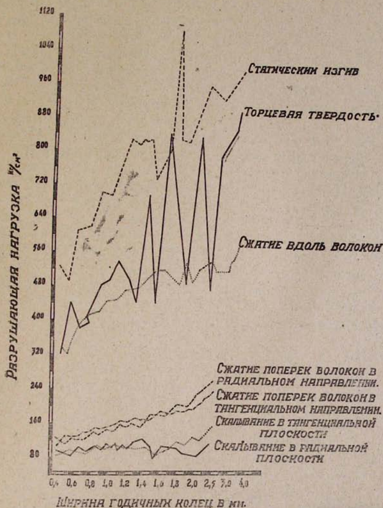
Рис. 3. Связь между шириной годичного кольца и механическими свойствами древесины дубов Армении
