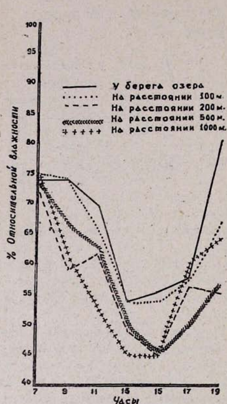
Рис. 1. Диаграмма динамики относительной влажности воздуха в течение дня на разных расстояниях от водоема.
