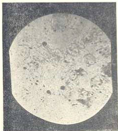
Фиг. 1. В поле зрения видны крупные пластинки \gamma\text{-}2\text{CaO}\cdot\text{SiO}_2 и непрозрачные корольки металла (Fe). Свет проходящий. Увеличение в 600 раз. Николи параллельные.
