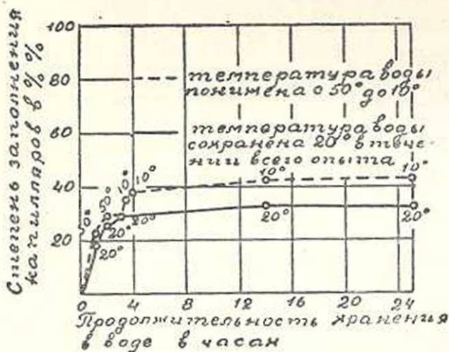
фиг. 6. Влагоемкость литондной пемзы в проц. от объема в зависимости от изменения температуры среды.
