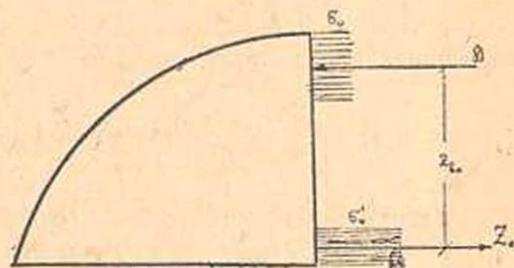
Рис. 5. Эпюра внутренних напряжений в стадии разрушения
