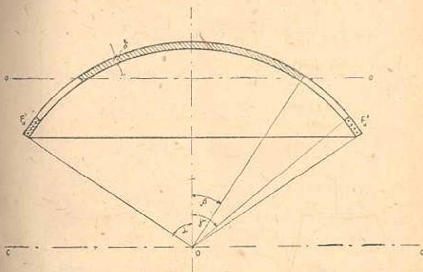
Рис. 1. Меридиональное сечение оболочки в стадии разрушения
