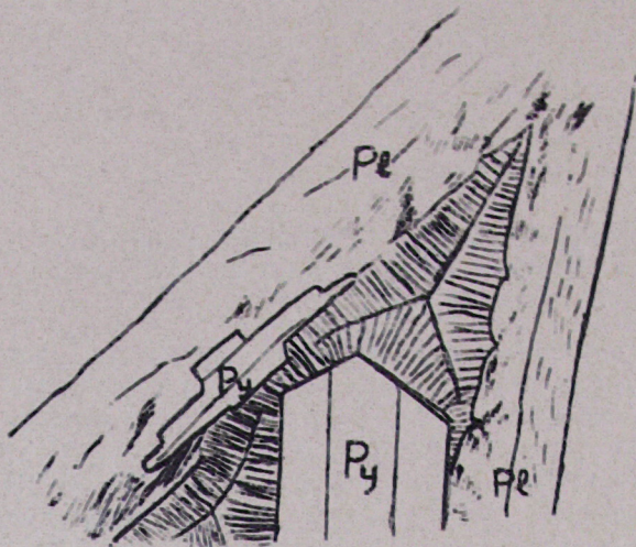
Фиг. 2. Заполнение межплагиоклазовых интерстий основной массы долеритовых базальтов радиально-волокнистым хлоритом. Вел. 0,5 мм.
