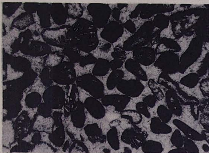
Фиг. 4. Органогенно-обломочный известняк. Наряду с хорошо окатанными обломками раковин в шлифе видны более редкие песчаники эффузивных пород. Шлиф ув. 40 с. Антарашат.
