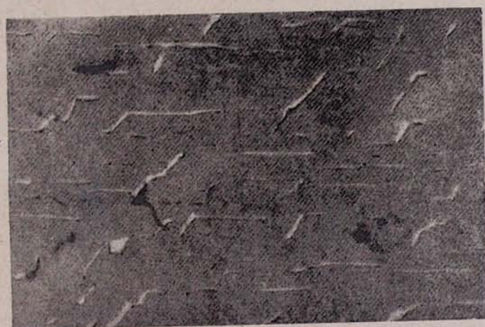
Фиг. 1—3. Формы выделения виттихенита в полях борнита. Пол. шлиф, ув. 350.
