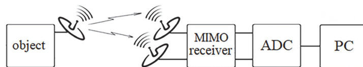
Рис.2. Структурная схема предлагаемой системы мониторинга за движущимся объектом: «object» – объект, «MIMO receiver» – MIMO приемник, «ADC» – АЦП, «PC» – персональный компьютер.
